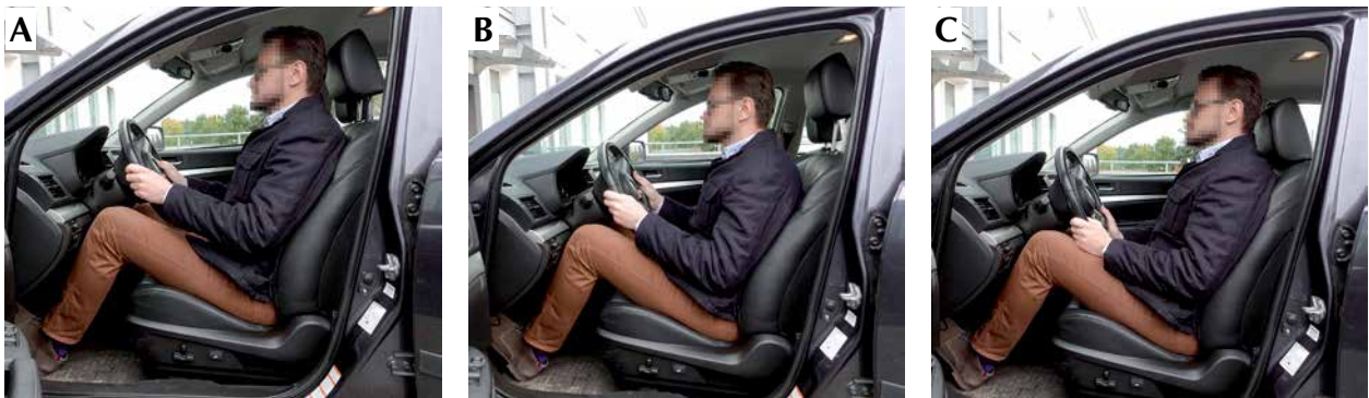
Ryc. 6. Orientacyjna ocena dostosowania zagłówka do wzrostu użytkownika pojazdu (A – prawidłowo, B – za daleko, C – za nisko) Fig. 6. General illustration of head restraint adjustment to the height of vehicle user (A – correct, B – too far, C – too low)
