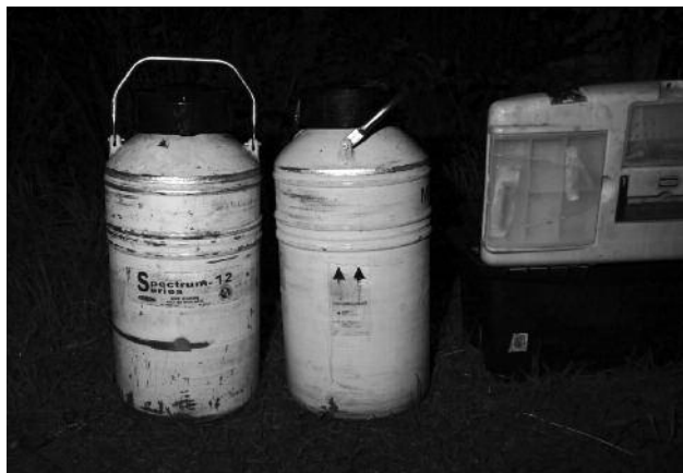
Ryc. 1. Rozszczelnione pojemniki do przechowywania ciekłego azotu.
