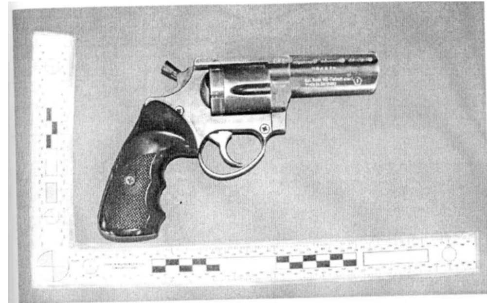
Ryc. 1. Rewolwer kaliber 6 mm "Cuno Melcher KG" (Niemcy), przeznaczony do strzelania 6 mm amunicją Flobert short.
