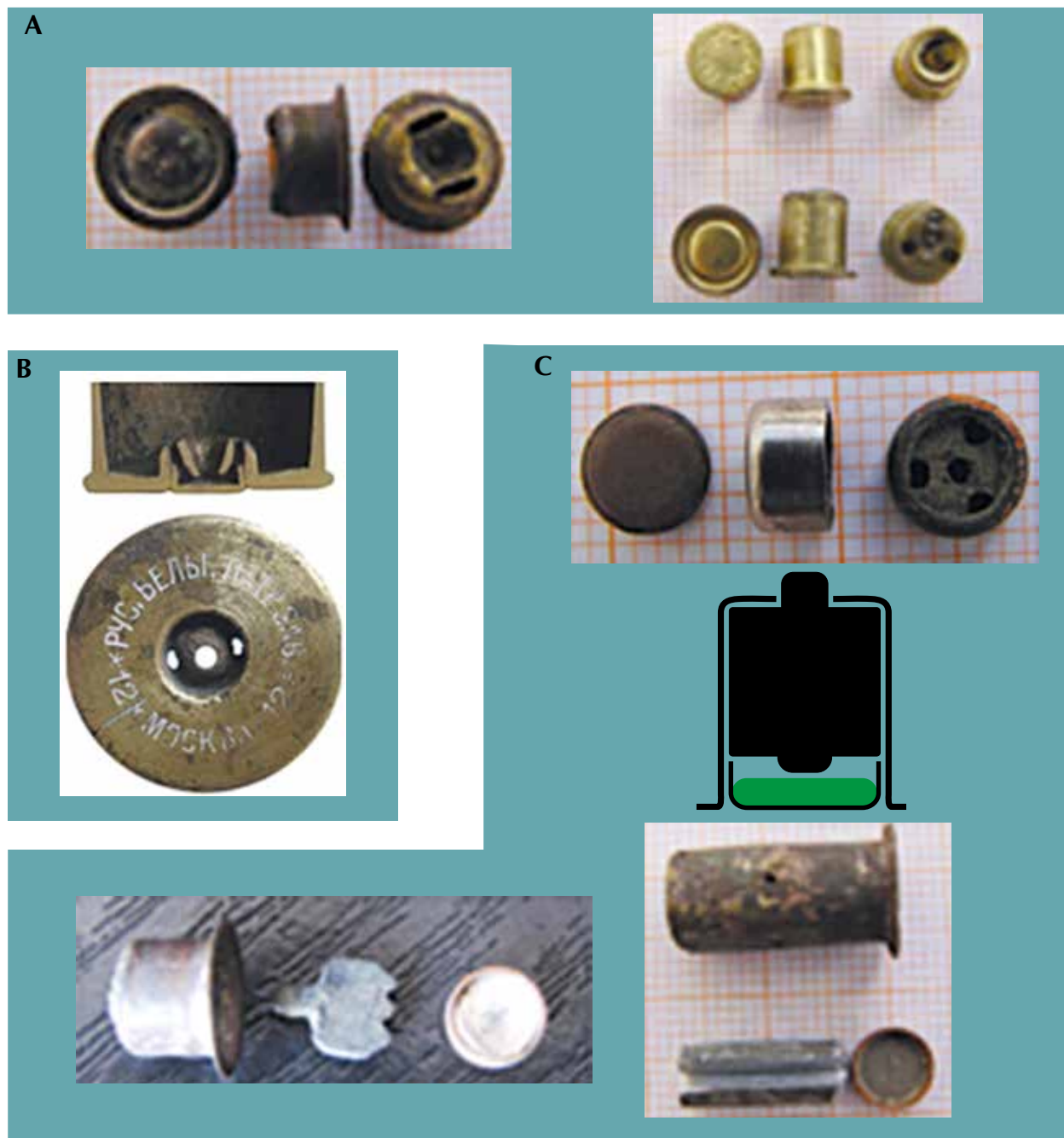
Ryc. 4. Spłonki kowadełkowe spotykane w starej papierowej amunicji myśliwskiej: A) typ myśliwski niski lub wysoki – Berdan i Boxer, B) typ wojskowy [ https://forum.cartridgecollectors.org/t/some-questions-regarding-shotshells-priming-systems/12256 ], C) rzadkie typy – wojskowy BOXER, BRAUN & BLOEM, „English anvil” [Zdjęcia ze zbiorów Muzeum Medycyny Sądowej UM we Wrocławiu]
