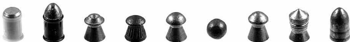
Ryc. 3. Śruciny użyte w badaniach. Od lewej: Prometheus Wadcutter, Prometheus Round Head, H&N Hollow Point, Kovohute Diabolo Standart, JSB Exact, Kovohute kula ołowiana, H&N Baracuda, H&N Silver Point, H&N Rabbit Magnum II
